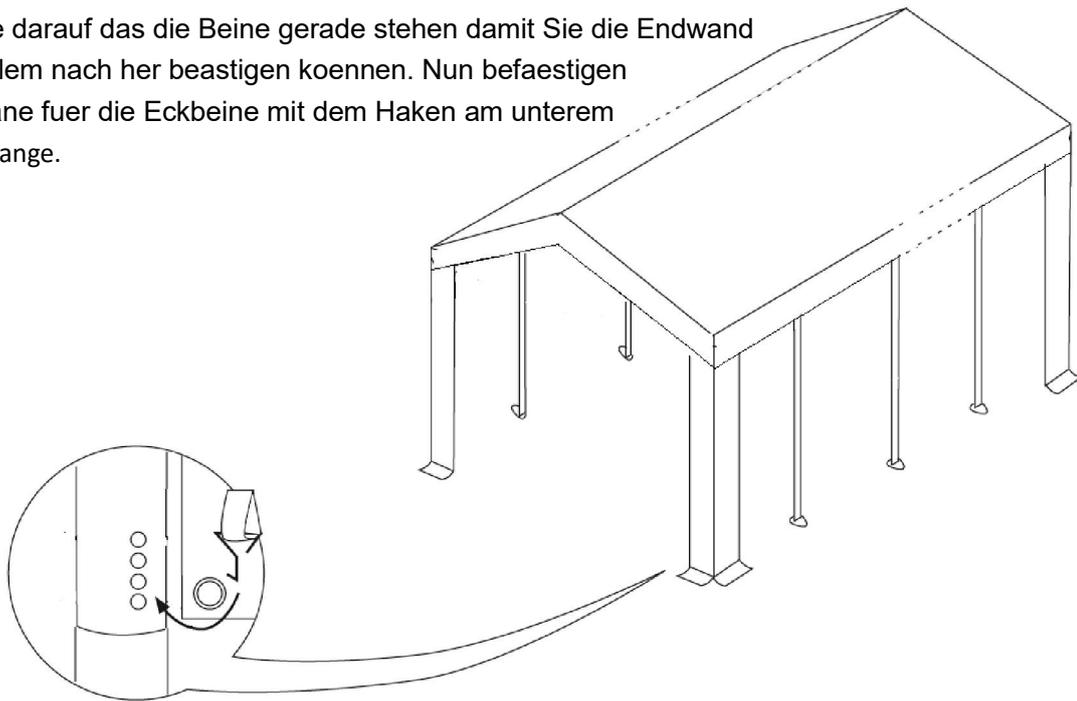
4. Entfalten Sie die Seitenwaende sowie die Vorder-und Rueckseitenwaende. Verbinden Sie diese mit den Spanngummis mit dem Gestell. Verbinden Sie die Seile mit den Haken am Boden. Achten Sie darauf die Seitenwaende und die Vor-Rueckwand mit dem Klettverschluss richtig zu Verbinden.
